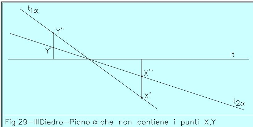
Fig.29-III Diedro-Piano  $\alpha$  che non contiene i punti X,Y
